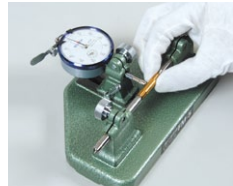
丸物の振れ測定为例です ワーク
